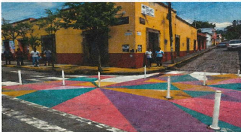
Tepoztlán, Morelos. Cruce seguro Pintura y señalética temporal para priorizar al peatón y mejorar la seguridad vial.
